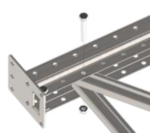
☞ Alle Schrauben müssen mit einem Anzugsdrehmoment von 15 Nm angezogen werden.
