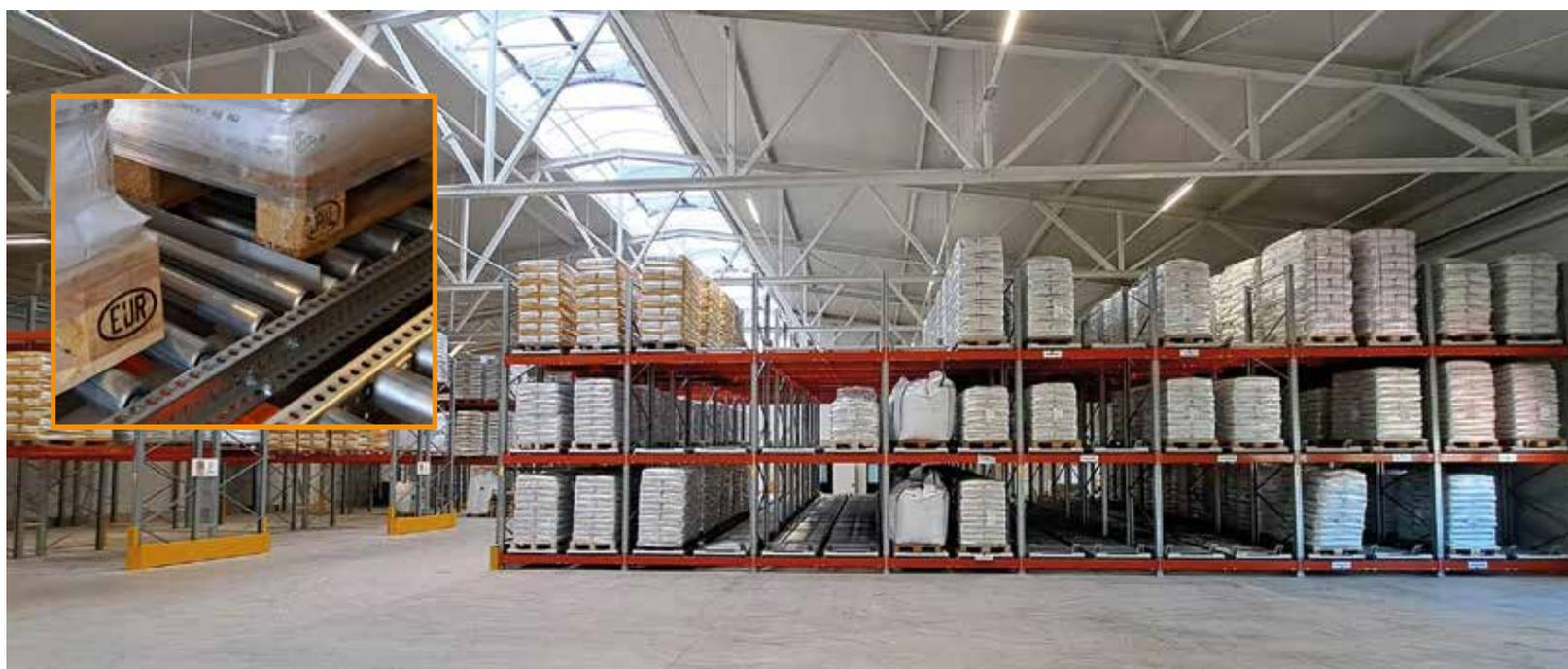
Blick auf den Durchlaufregalblock mit eingebautem Palettenstop (kleines Foto) in der neuen 1.800m<sup>2</sup> großen Halle
